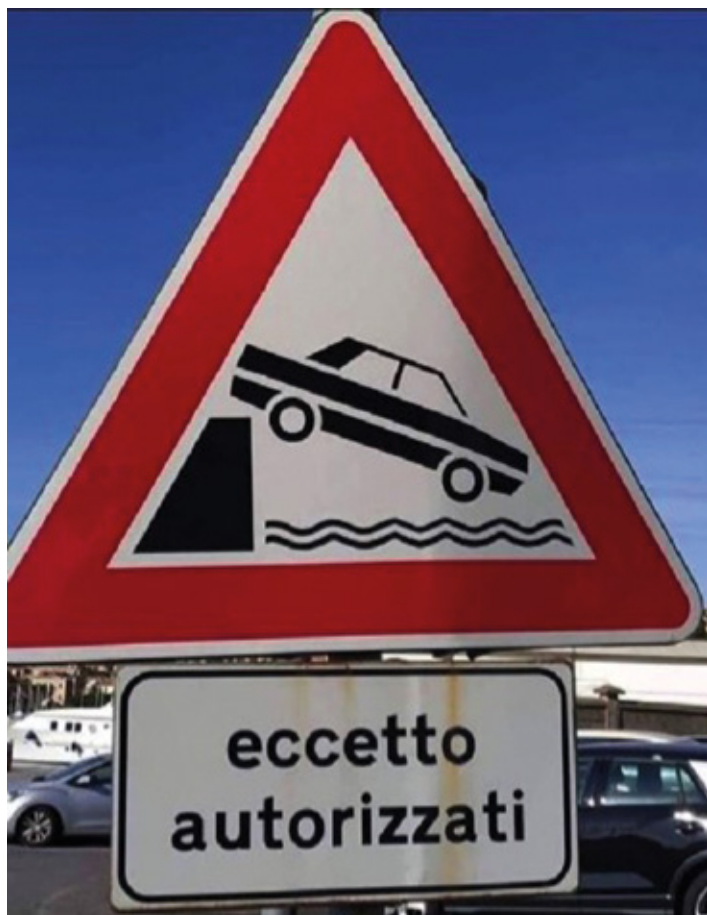
Carenza di progettazione e controllo: impiego improprio di pannello integrativo
